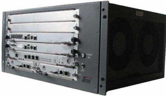
Программный коммутатор – это "интеллектуальный центр" сети следующего поколения. Он обрабатывает вызовы, управляет шлюзом доступа и шлюзом соединительных линий, предоставляет услуги и создает условия для получения доходов.
